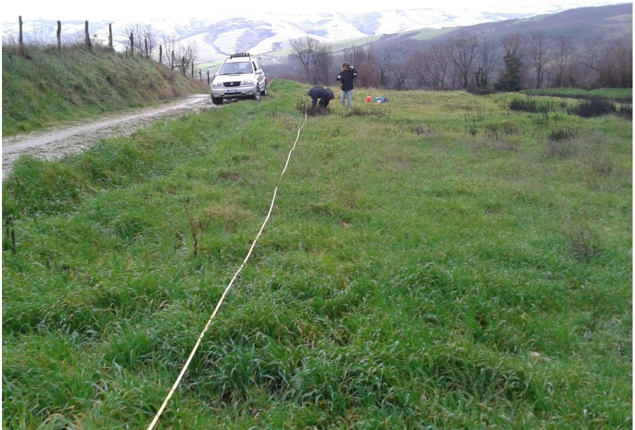
Foto 2: lo stendimento sismico a rifrazione
