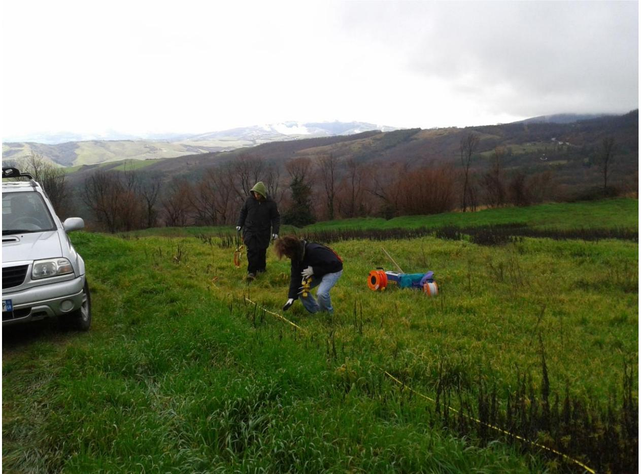
Foto 1: immagine dell'acquisizione delle onde P nella prospezione sismica
